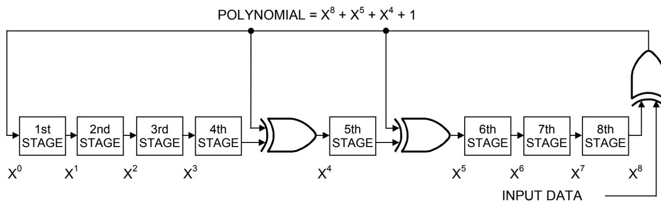
**Figure 3. DS2411 EQUIVALENT CIRCUIT**
